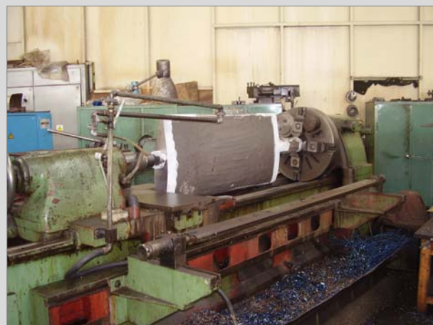
Opracování horního čepu rozváděcí lopaty
